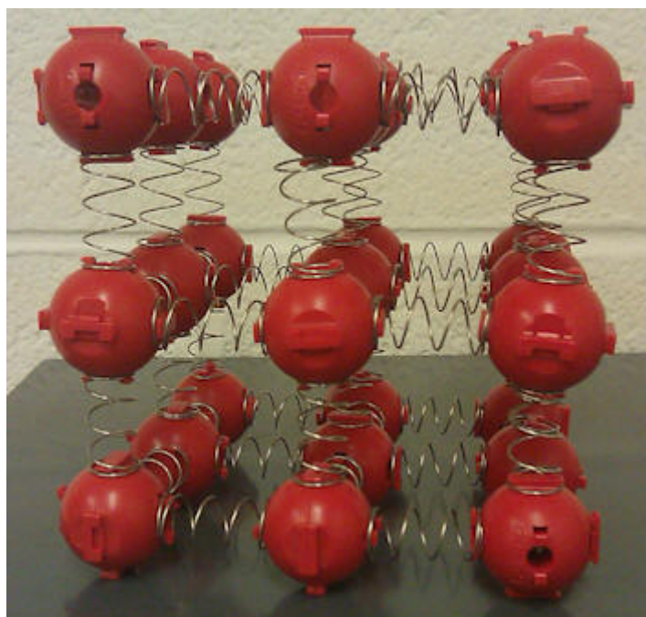
Rysunek 4. Model sprężynowy przestrzennego układu atomów.
