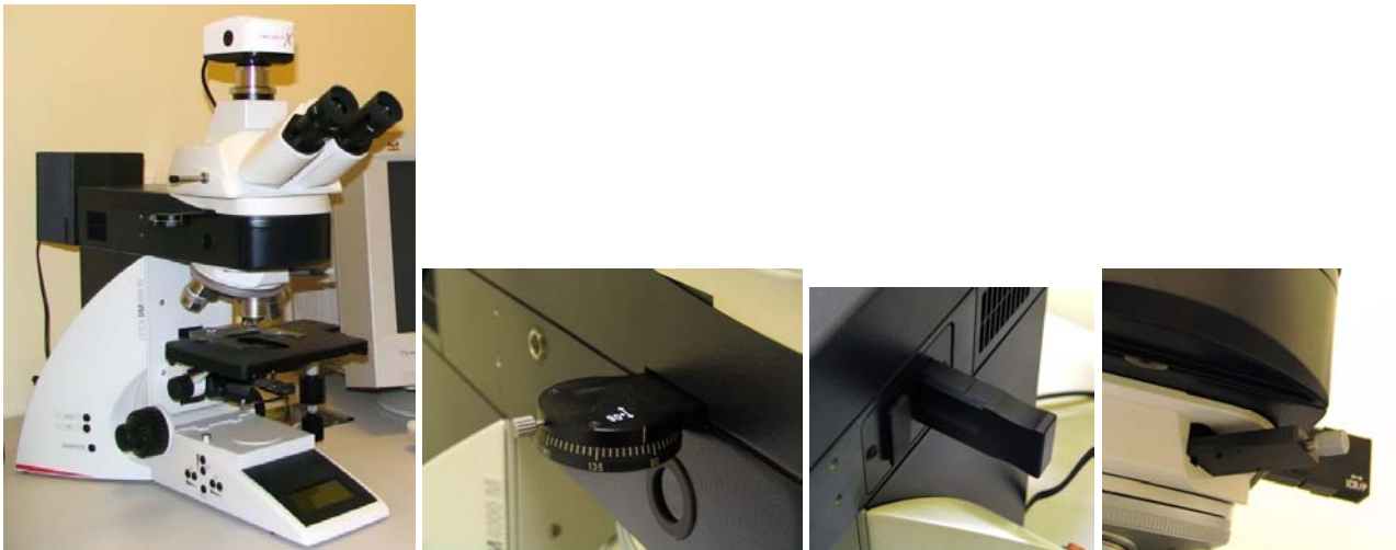
Rysunek 56. Nowoczesny mikroskop do badań metalograficznych wraz z, polaryzatorem, filtrami świetlnymi oraz do interferencyjnego kontrastu różniczkowego
